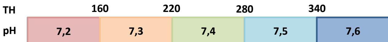
Tyto hodnoty vycházejí z naší zkušenosti. Jsou doporučeny pro udržení kontaktu součástí s vodou a pro správné fungování měřicích sond.
