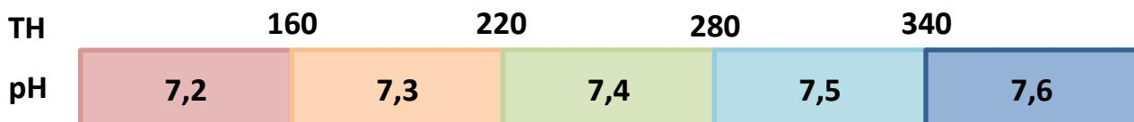
I valori riportati si basano sulla nostra esperienza. Si raccomanda di rispettarli al fine di preservare gli elementi a contatto con l'acqua e il corretto funzionamento delle sonde di misurazione.
