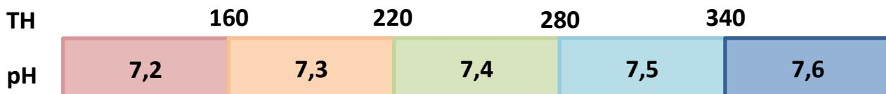
Deze waarden zijn gebaseerd op onze ervaringen. Ze worden aanbevolen om de onderdelen in contact met water en de goede werking van de meetsondes in stand te houden.
