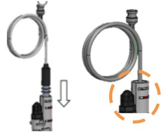
Eine Sonde, die zu 100% durch das Rohr des Sondenhalters geschützt ist
